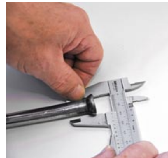
Allt under 20 millimeter är farligt. Kontrollmät och byt ifall den inte håller måttet!
